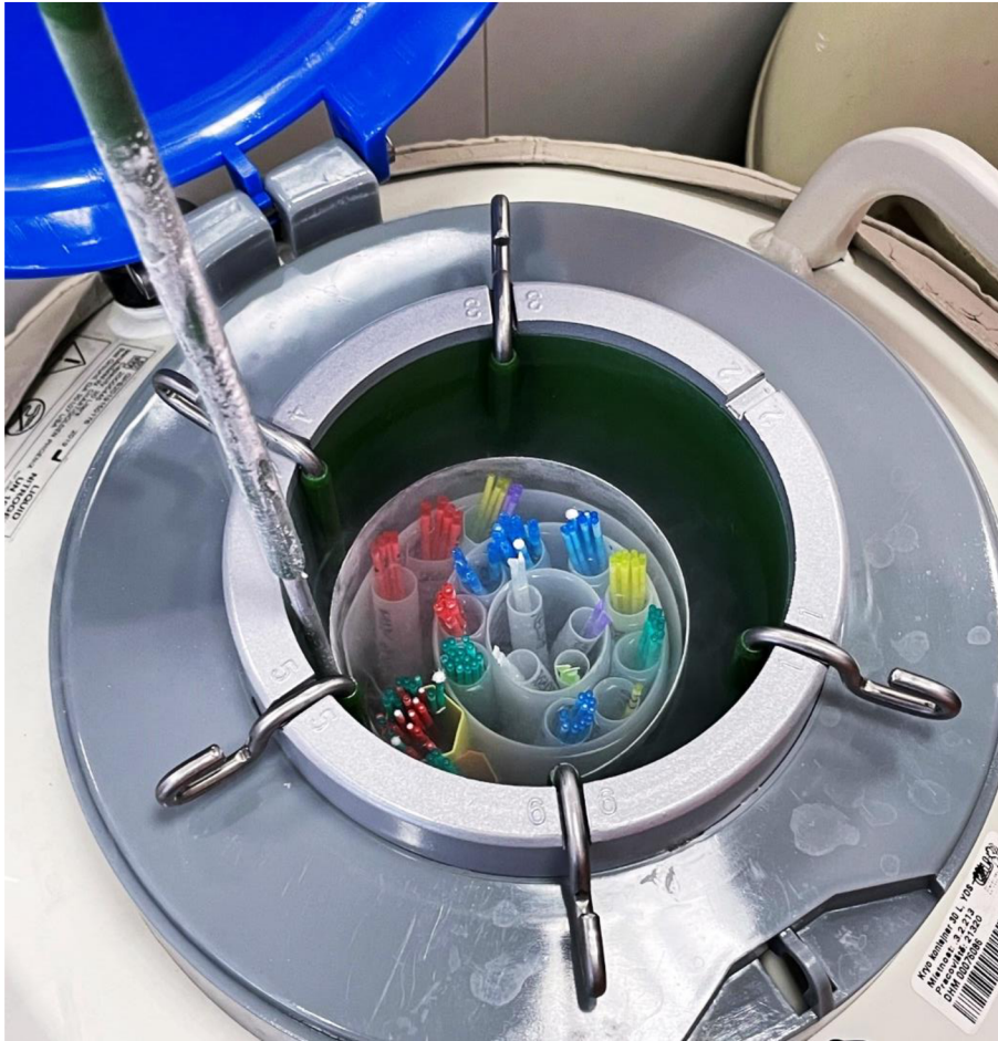
Obr. č. 5: Kontejner s tekutým dusíkem a uloženými inseminačními pejetami rozdělené v gobletách (archiv autora)
