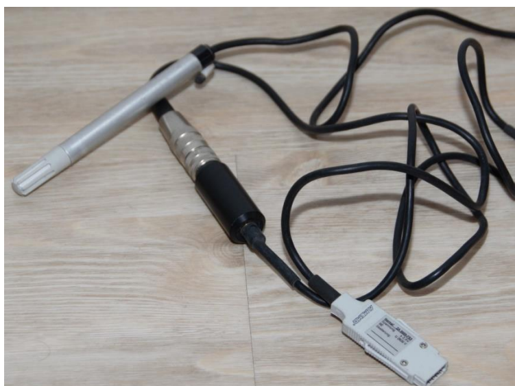
Obrázek 12 Čidlo relativní vlhkosti a teploty vzduchu
