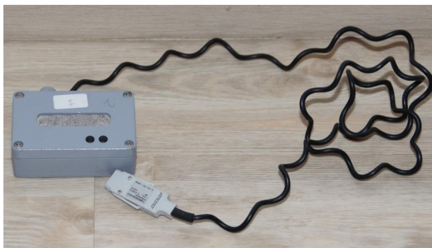
Obrázek 13 Snímač obsahu CO 2 ve vzduchu
