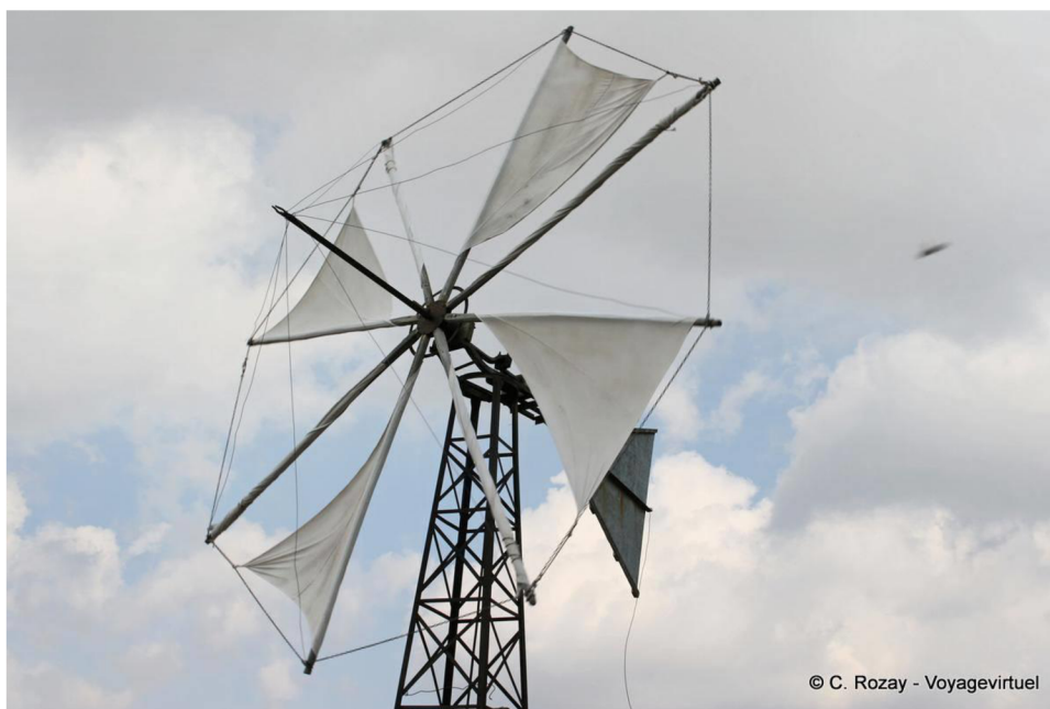
Obr. 1.6 – Rotor krétského větrného čerpadla s typickými plachtami místo lopatek
