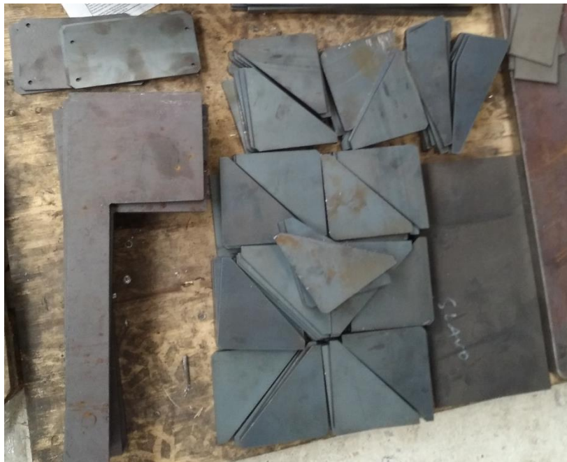
Obr. 14: Časti konštrukcie delené pomocou CNC frézy, (Foto:autor)
