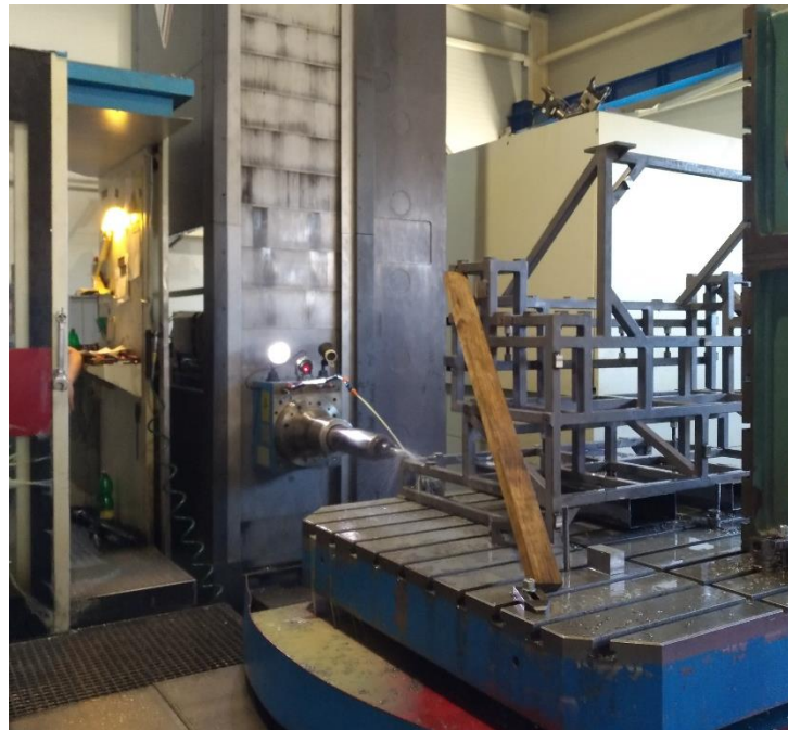
Obr. 12: Výrobok v procese obrábania CNC zariadením, (Foto:autor)
