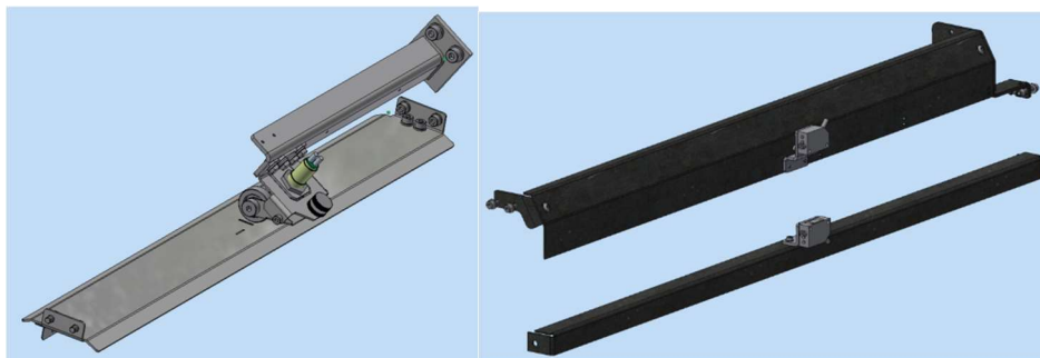
Obr. 33) Ultrazvukové čidlo snímající místo řezu papíru
