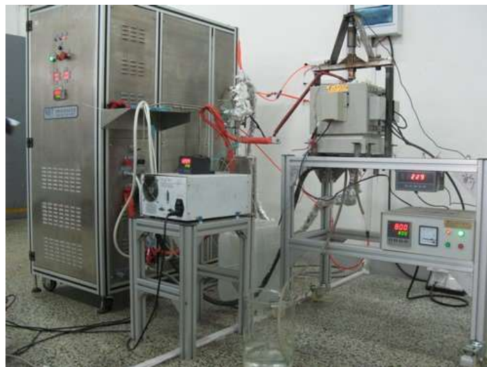
Obrázek 10 Vysokoteplotní elektrolýza vody [24]
