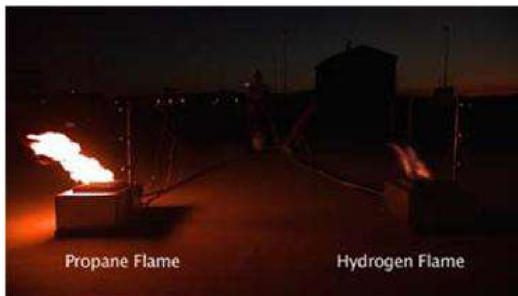
Obrázek 19 Vizualizace hoření vodíku 2 [52]
