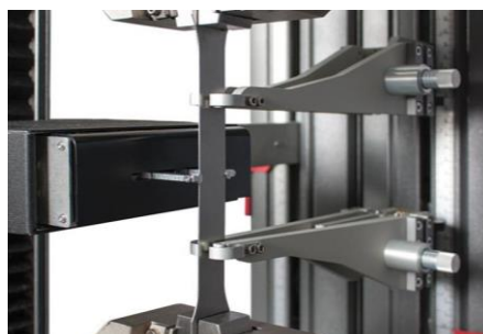
Obr. 12 Upnutí plechu do plochých čelistí [4]
