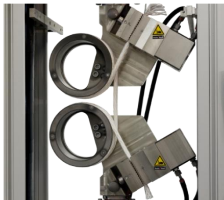
Obr. 11 Čelisti používané k uchycení drátu [4]
