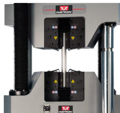
Obr. 13 Zkoušení trubek tahem [5]
