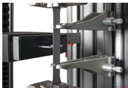
Obr. 12 Upnutí plechu do plochých čelistí [4]
