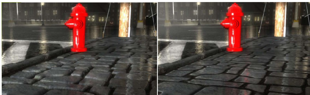
Obrázek 3.9: Porovnanie parallax mappingu a normal mappingu (zdroj 1 ). Pri pohľade na normal mapping napravo je vidieť, že dlážka plochá. Pri parallax occlusion mappingu-u je jasne vidieť, že dlaždice sú vyvýšené.
