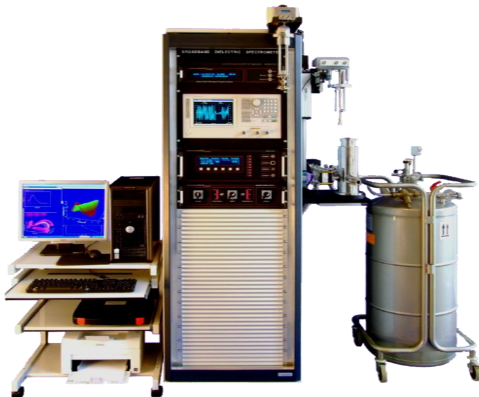
Obr. 32: Impedanční analyzátor Novocontrol Technologies - Concept system 80, převzato z [28]
