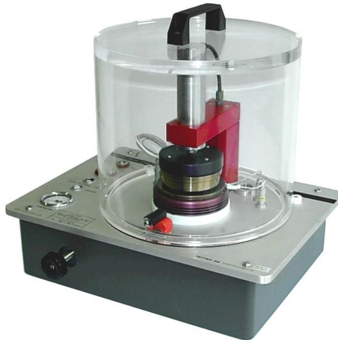
Obr. 29: Měřicí přípravek pro pevná dielektrika Tettex 2914, převzato z [25]
