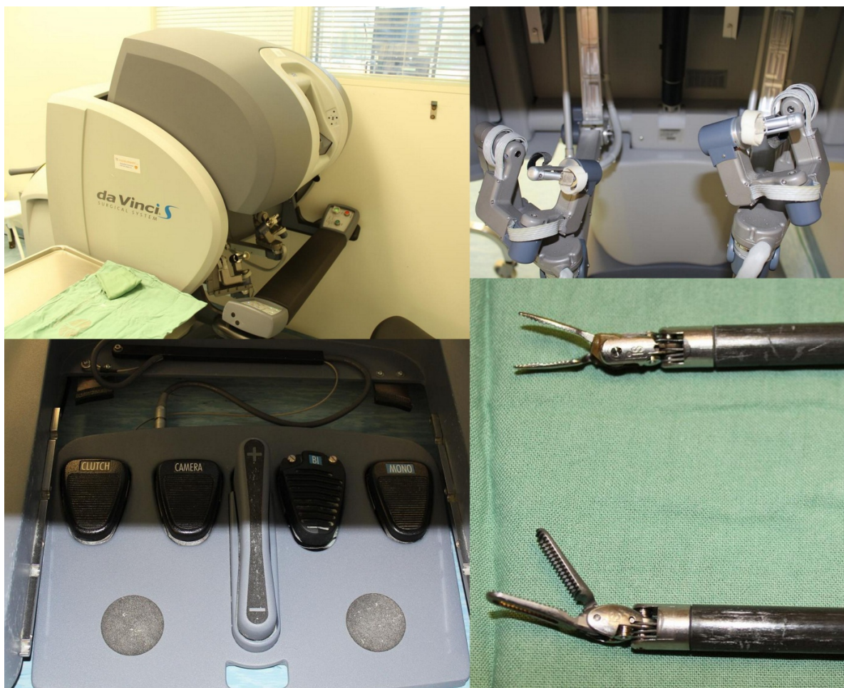
Obr. 2: Robotický systém daVinci S HD a jeho jednotlivé komponenty, ovládací a zobrazovací část, manipulovatelnost nástrojů robota (vlastní foto)
