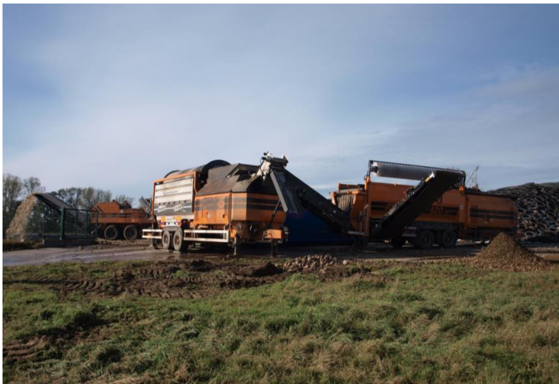
Obrázek 18 - Linka na zpracování cukrové řepy pro potřeby bioplynové stanice
