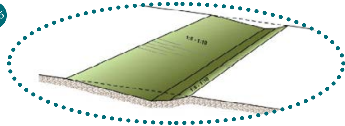
Vzorový příčný řez průlehem:
