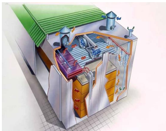
Obr. 12 Schéma vysokoteplotní sušárny řeziva
