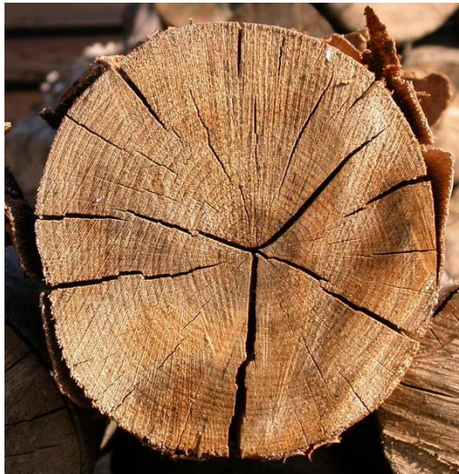
Obr. 3 Výsušná radiální trhlina
