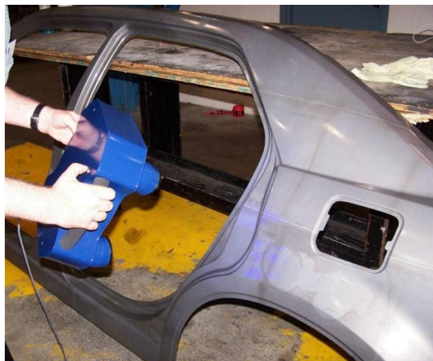
Obr. 33 Proces měření systémem AutoGrid® Compact [46]
