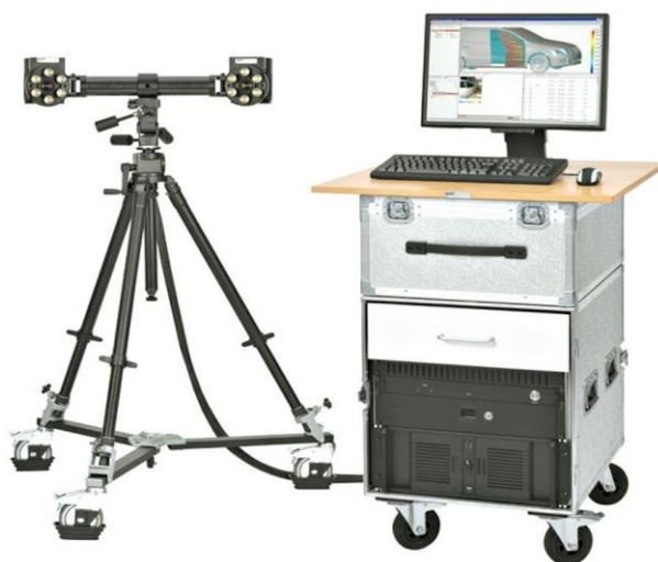
Obr. 25 Systém PONTOS i s kalibračními tyčemi a počítačem [37]
