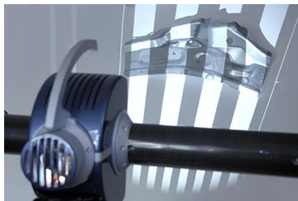
Obr. 35 Skenování vylisku za pomoci projektoru bílého světla [51]
