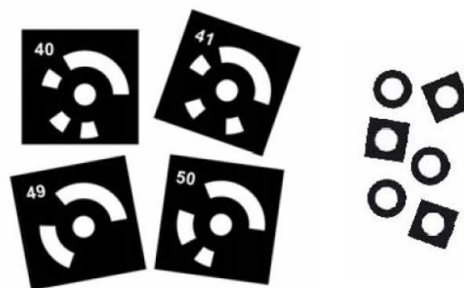
Obr. 27 Kódované a nekódované referenční body [39]
