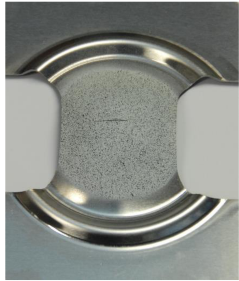
Obr. 44 Ukázka přijatelně porušeného vzorku [54]
