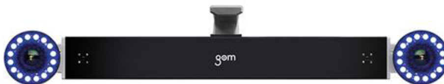
Obr. 24 Snímací aparát systému PONTOS [35]
