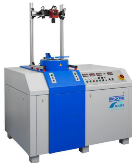
Obr. 49 Automatizovaný stroj pro Nakajima test Erichsen 145-60 s připevněným systémem ARAMIS [54]
