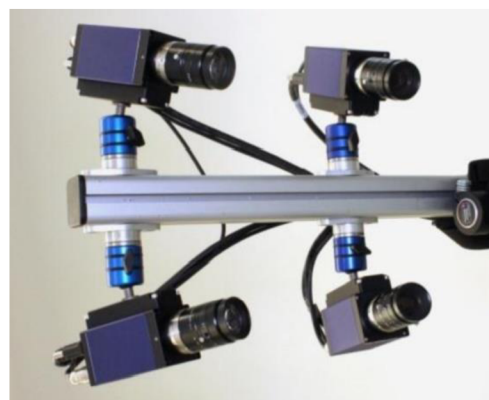
Obr. 32 Měřicí hlava systému AutoGrid ® Vario [41]
