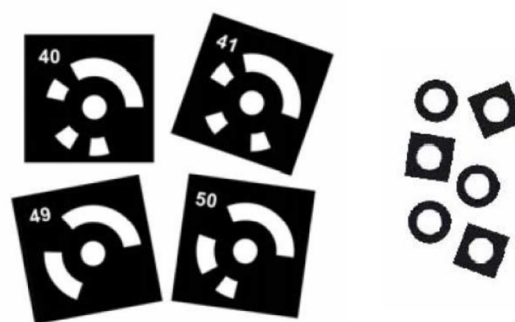
Obr. 27 Kódované a nekódované referenční body [39]
