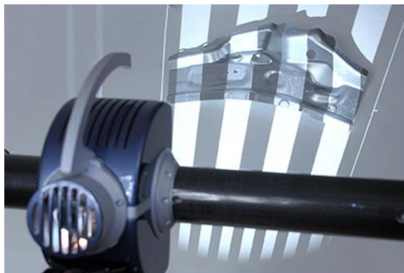
Obr. 35 Skenování vylisku za pomoci projektoru bílého světla [51]
