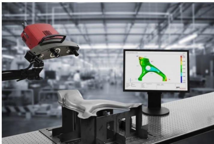
Obr. 1 Měření 3D optickým měřicím systémem [5]
