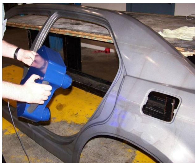
Obr. 33 Proces měření systémem AutoGrid ® Compact [46]
