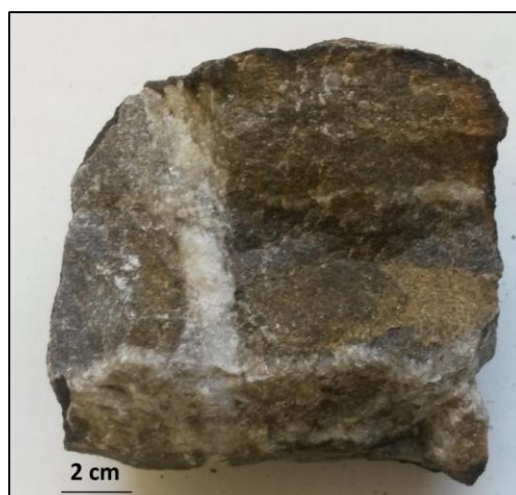
Obr. č. 9: velmi jemnozrný pískovec s hydrotermálními žilkami tvořenými převážně kalcitem, méně barytem (vzorek 3).
