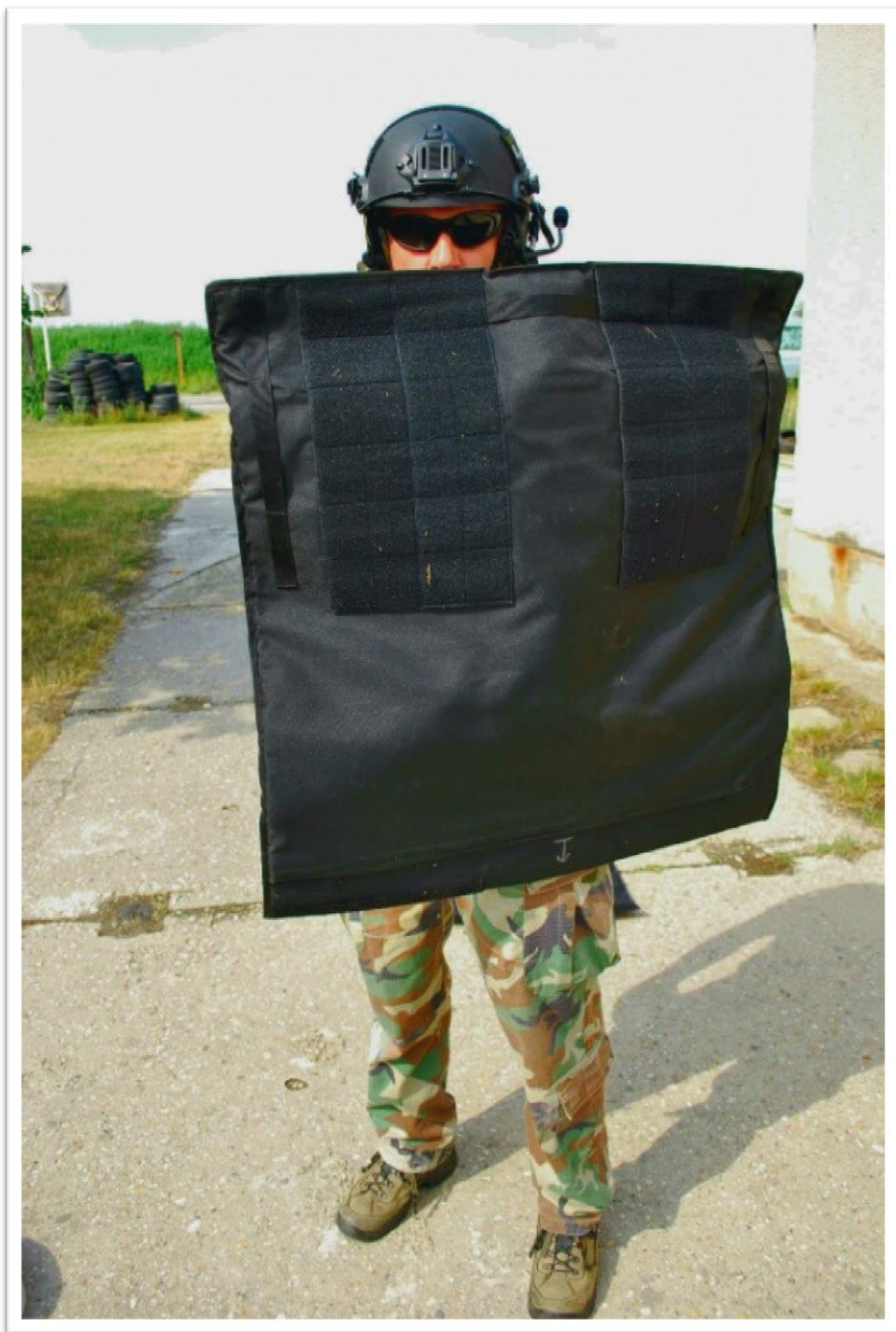
Obrázek č. 9: Balistická přikrývka MPBSB použita jako měkký balistický štít (zdroj: vlastní)
