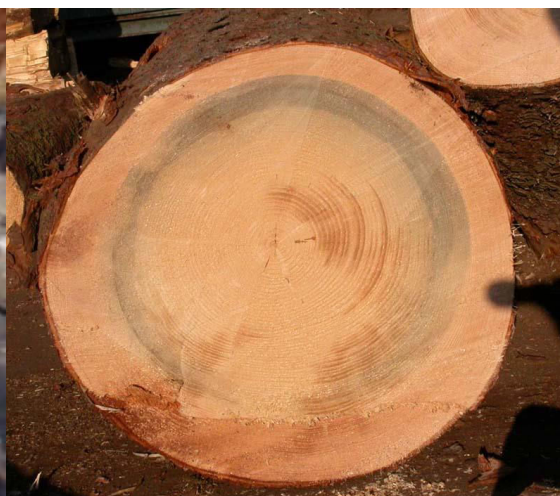
Obr. 4, Napadení dřevozbarvující houbou (Anon. 2012)
