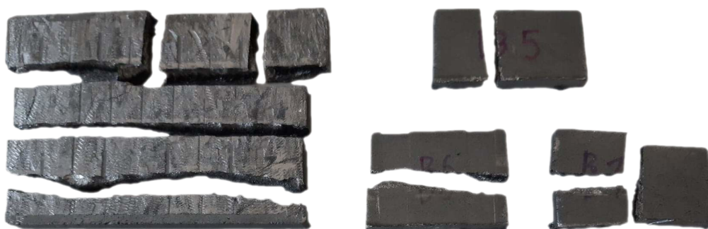
Obrázok 6.3: Rozlomená základňa a vybrané rebrá chladiča.
