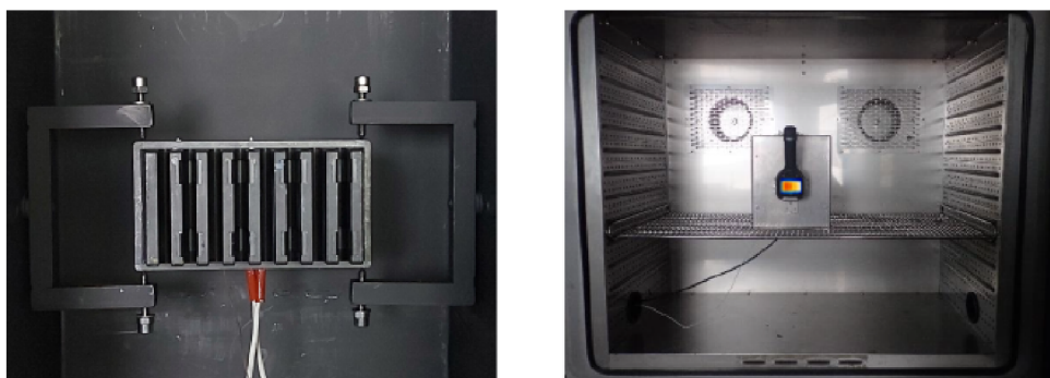
Obrázok 4.1: Umiestnenie chladiča v meracom boxe (vľavo) a boxu v termostatickej komore (vpravo).
