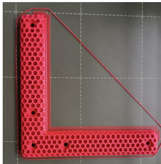
Obrázek 25.- Vrchní díl rámu skla vyrobená na 3D tiskárně
