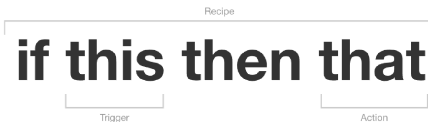
Obrázek 2.7: Schéma služby IFTTT. Zdroj: [15]
