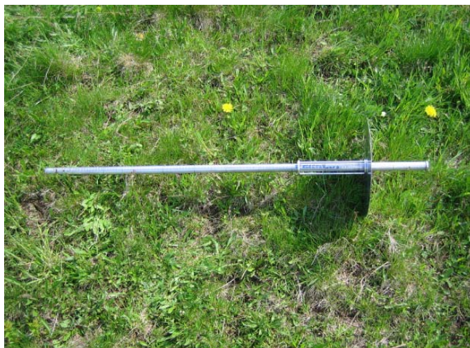
Obr. 14: Rising plate meter , používaný pro měření výšky porostu. Foto: Pavelčík P.
