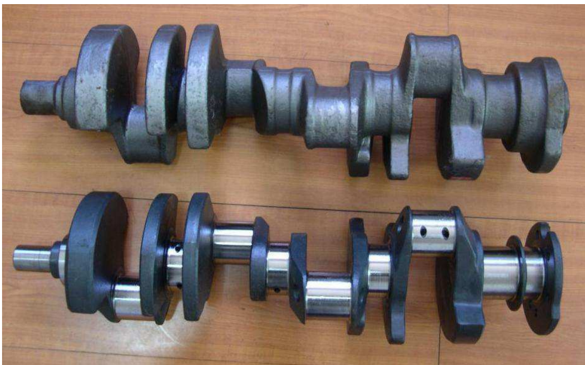
Obr. 2 Kovaná a následně obráběná kliková hřídel [9]
