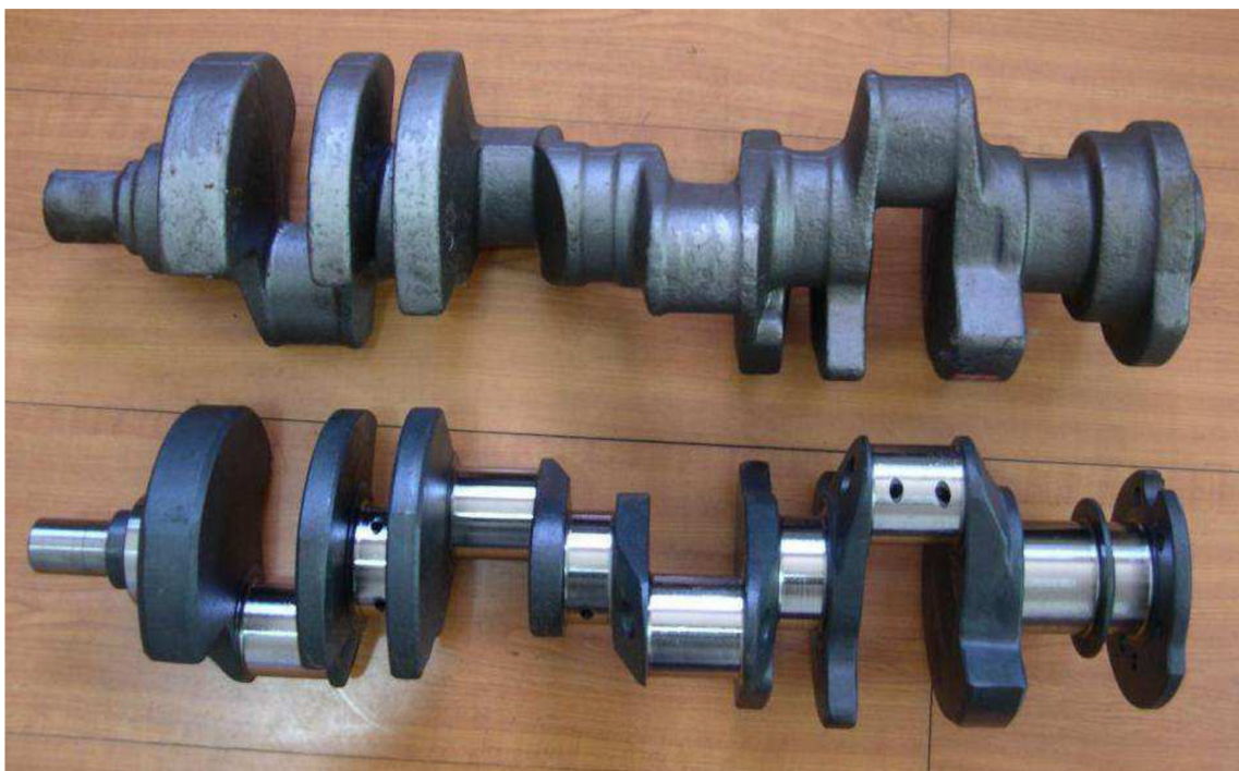
Obr. 2 Kovaná a následně obráběná kliková hřídel [9]
