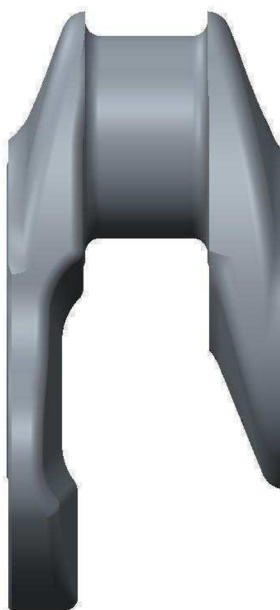
Obr. 10 Model zalomení klikové hřídele
