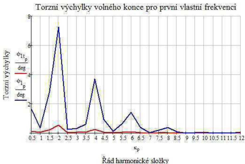
Obr. 42 Torzní výchylky pro první vlastní frekvenci s a bez tlumiče
