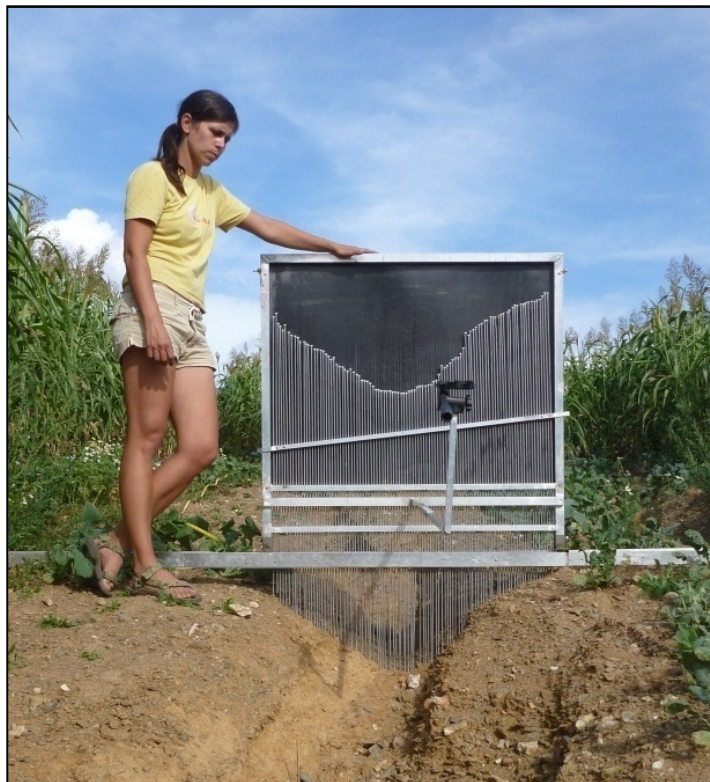
Obr. 20: Zaměřování příčného profilu erozní rýhy Erodoměrem
