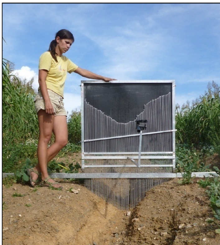
Obr. 20: Zaměřování příčného profilu erozní rýhy Erodoměrem
