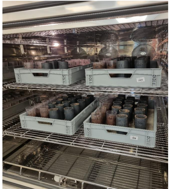
Obrázek 12: Plastové válečky vložené v komoře weise (zdroj vlastní).
