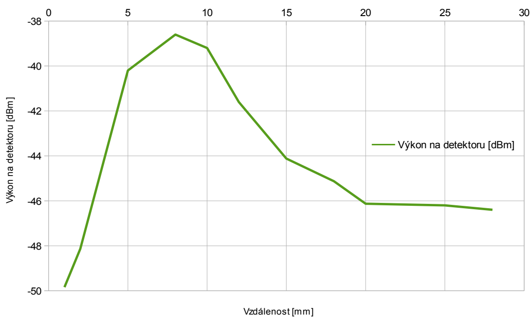
Obr. 5.16: Graf závislosti výkonu na oddalování vlákna od destičky.
