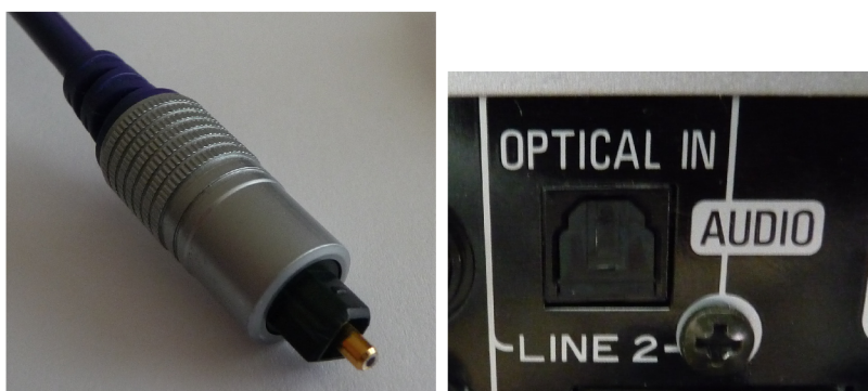
Obr. 3.2: TosLink: konektor a optický port.
