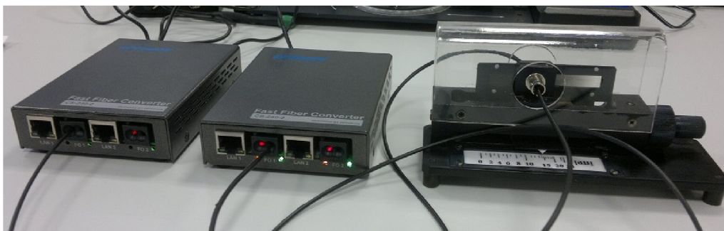
Obr. 5.4: Dvojice převodníků OPTOKON CS-240-2 v zapojení s útlumovým článkem.
