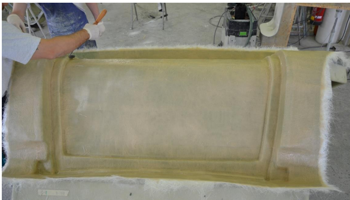
Obr 4.2 Ukázka ruční laminace dílu.
