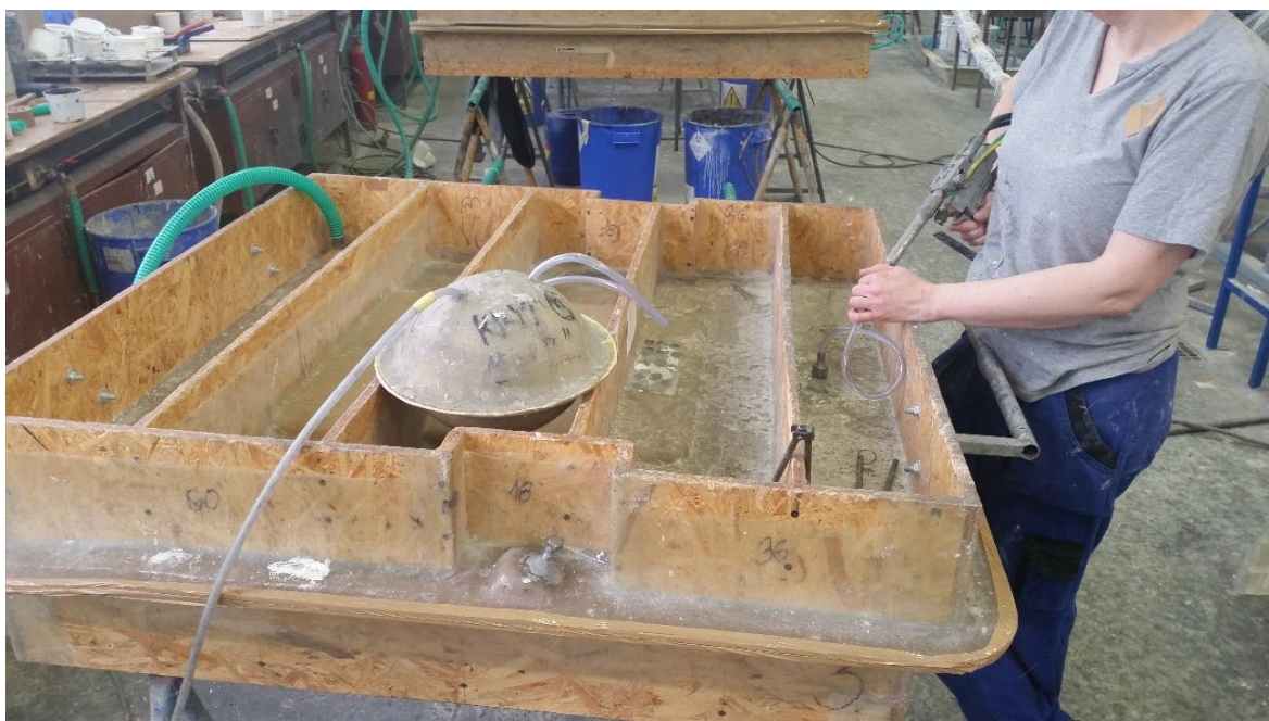
Obr 4.3 Ukázka plnění formy metodou RTM.
