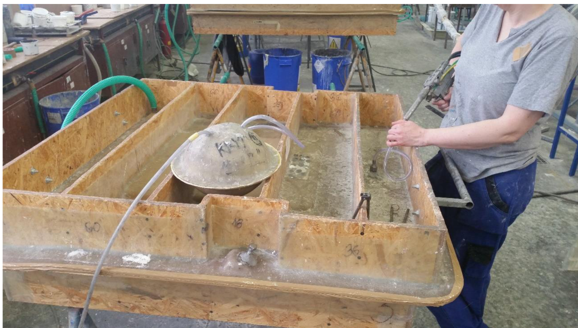
Obr 4.3 Ukázka plnění formy metodou RTM.
