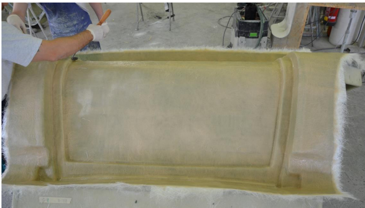
Obr 4.2 Ukázka ruční laminace dílu.
