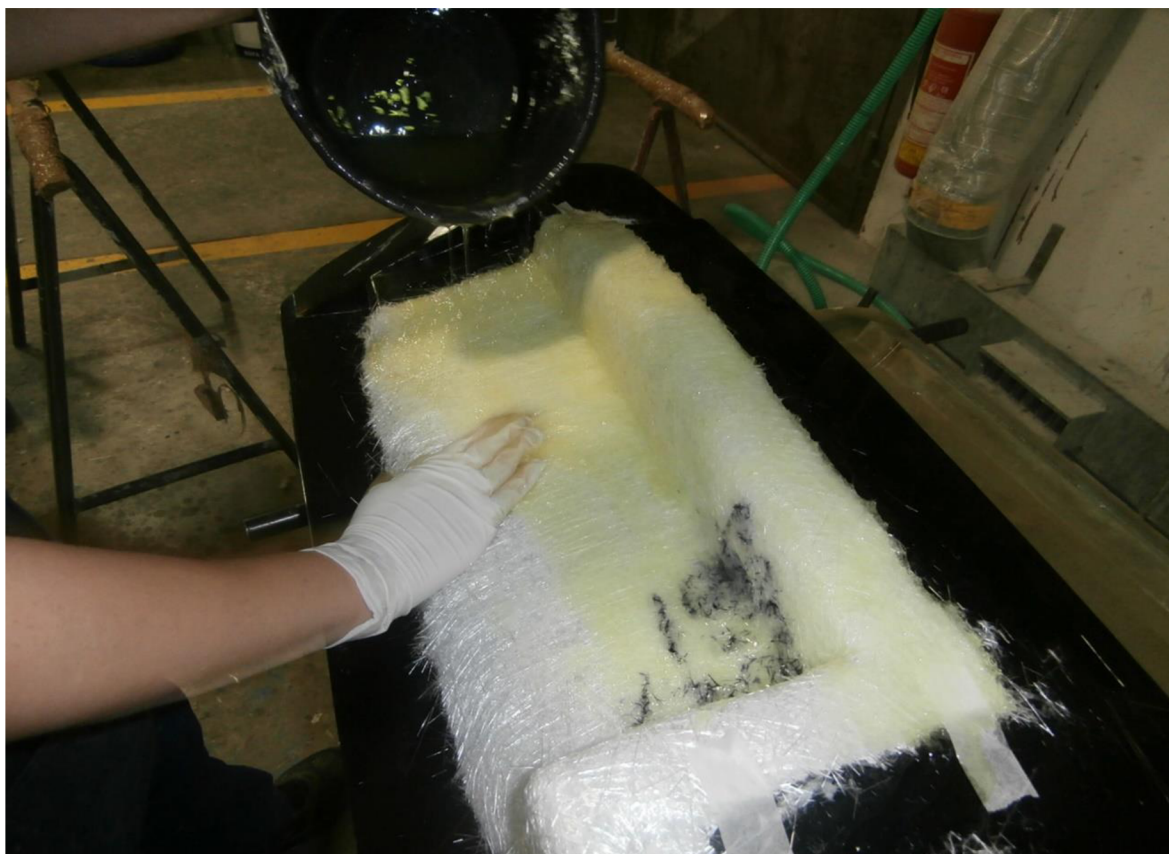
Obr 4.4 Ukázka vakuově - vypěňovací výroby dílu.
