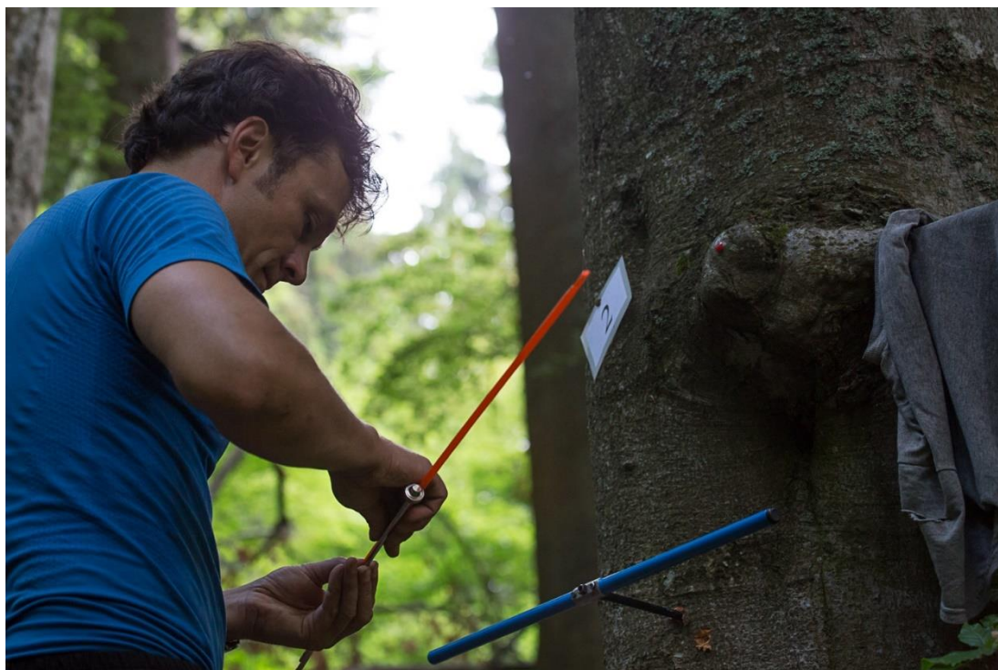
Obrázek 6: Vývrt byl proveden přírůstovým nebozezem a uložen do transportní schránky. (zdroj: remoteforests.org)
