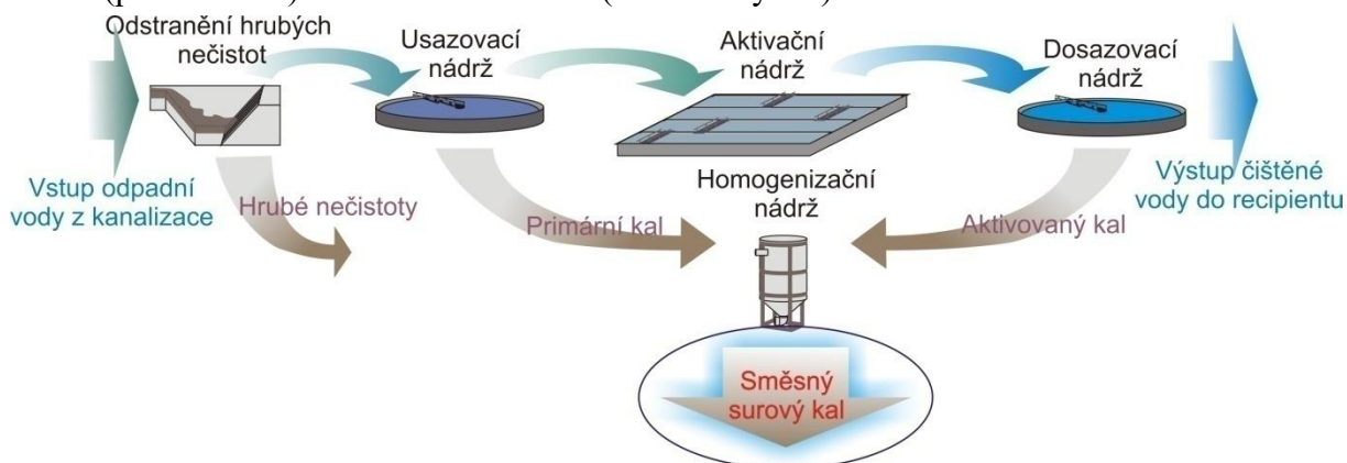
Obr. 4: Technologické schéma čistírny odpadních vod
