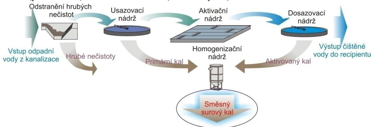
Obr. 4: Technologické schéma čistírny odpadních vod
