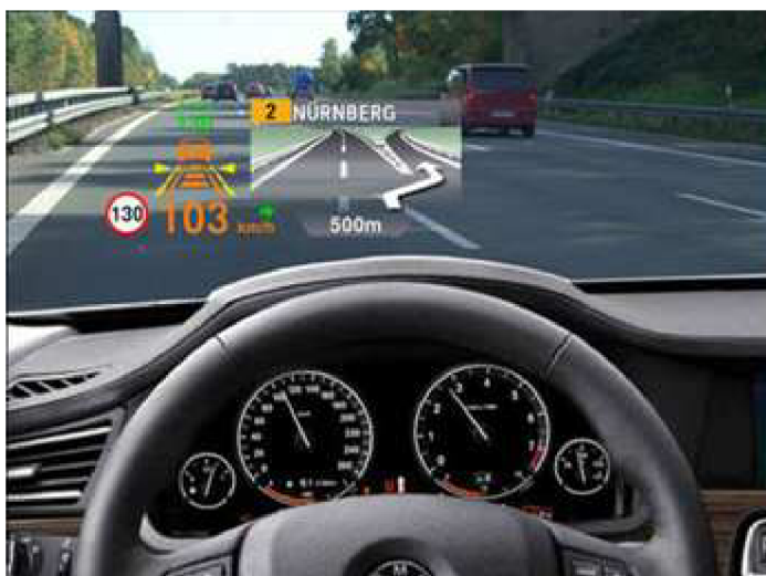
Obr. 10 Umístění HUD na čelním skle (BMW)[21]
