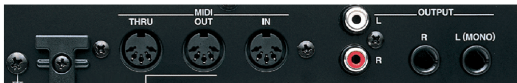
Obr. 1.1: Zadní panel elektronického syntezátoru s trojicí konektorů MIDI
