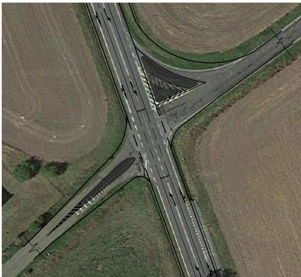
Obrázek 11: Původní a navrhovaná změna křižovatky
