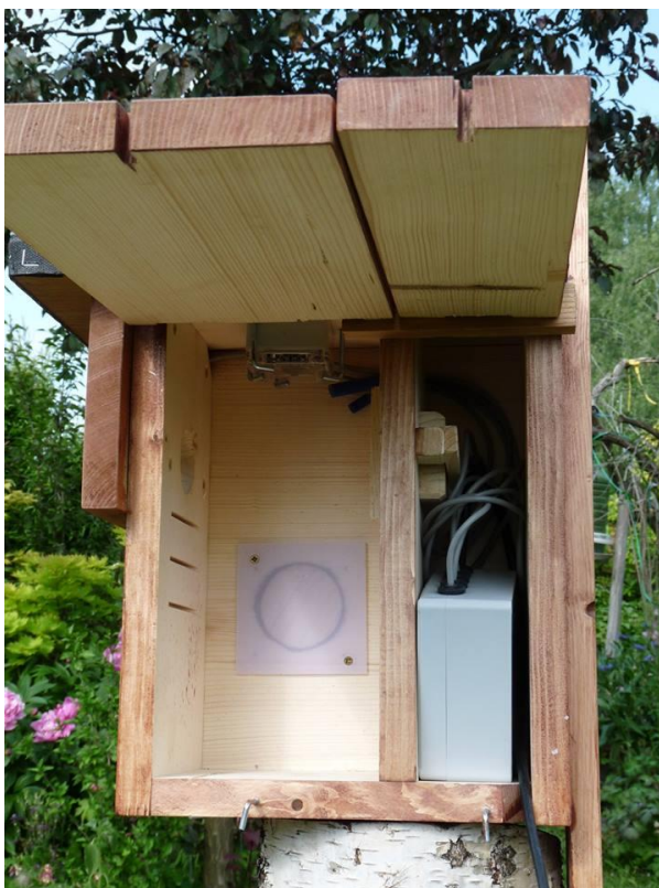
Obr. 8: Pohled do chytré ptačí budky, vpravo dole je umístěna počítačová řídicí jednotka (autor: Vlastimil Osoba, 2016).
