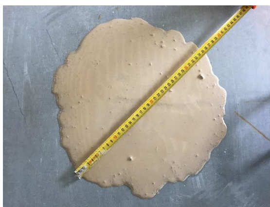
Obrázek 26: Stanovení hodnoty rozlití
