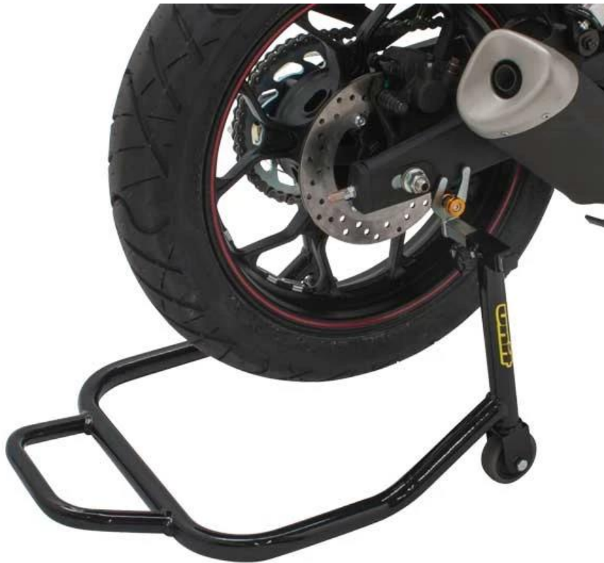
Obr. 4 Zvedání motocyklu za rolny kyvné vidlice [7]
