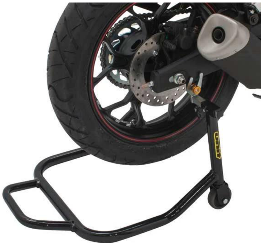
Obr. 4 Zvedání motocyklu za rolny kyvné vidlice [7]
