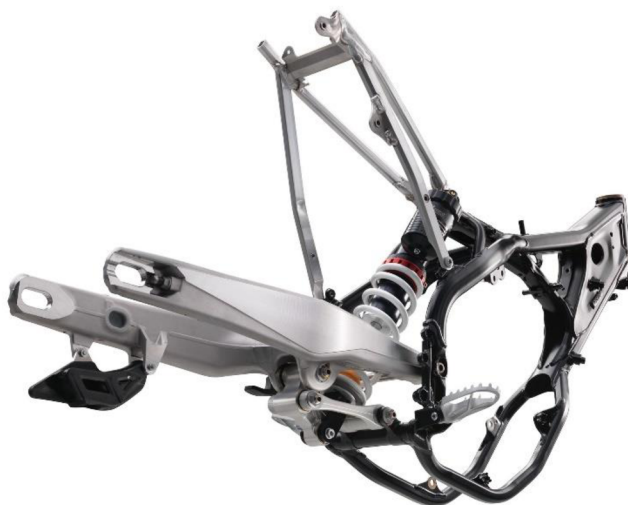
Obr. 8 Kyvná vidlice s pákovým mechanismem [13]
