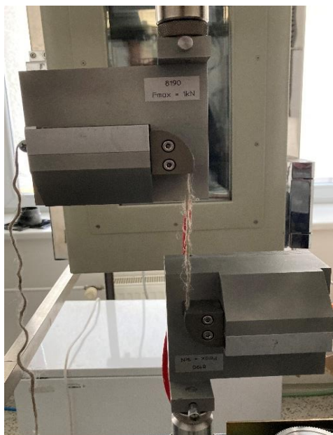
Obr. 26: Instrumentace tahové zkoušky vláken
