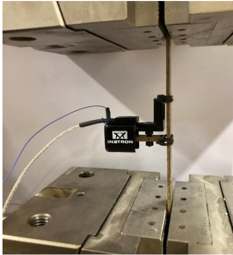
Obr. 28: Instrumentace tahové zkoušky za použití extenzometru
