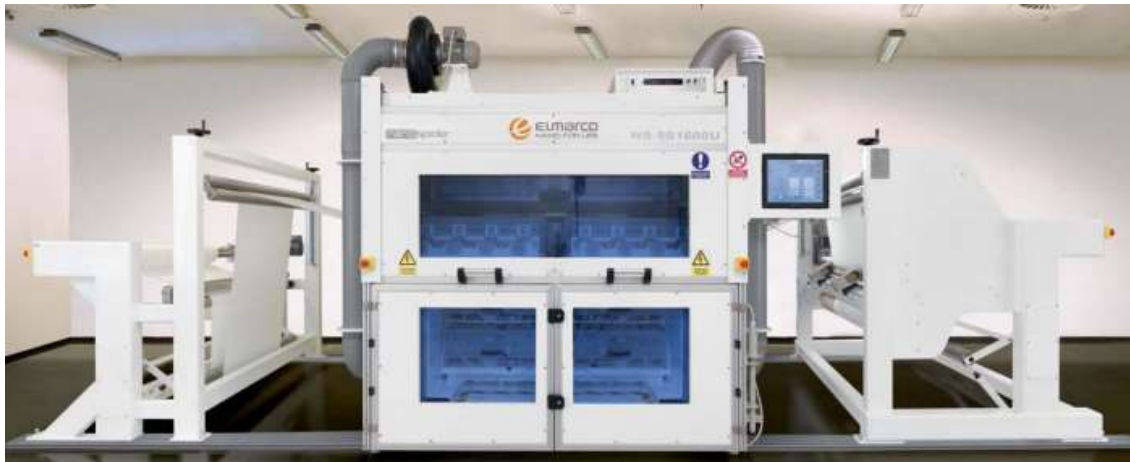
Obrázek 34 – Produkční linka NS 8S1600U pro průmyslovou produkci nanovláken [81]
