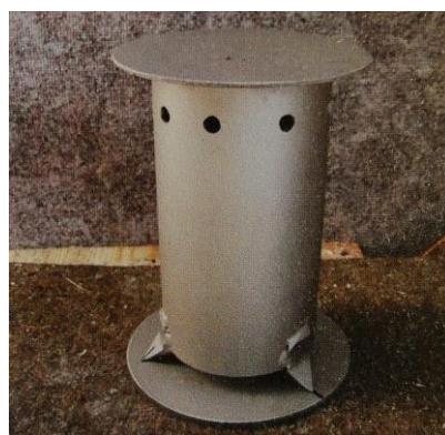
Obr. 17 Kovový válec s průduchy s vloženou např. svíčkou může sloužit jako nouzové topení. [7]
