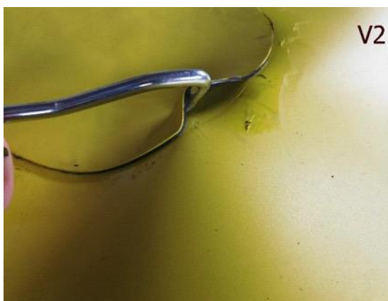
Obr. 51 – Zobrazenie identifikácie netesností vo vzorkách A6 a A8 pomocou odtrhovej ihly [zdroj:autorka]
