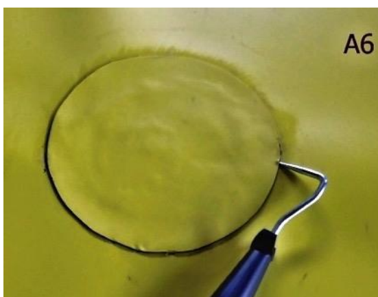
Obr. 51 – Zobrazenie identifikácie netesností vo vzorkách A6 a A8 pomocou odtrhovej ihly [zdroj:autorka]
