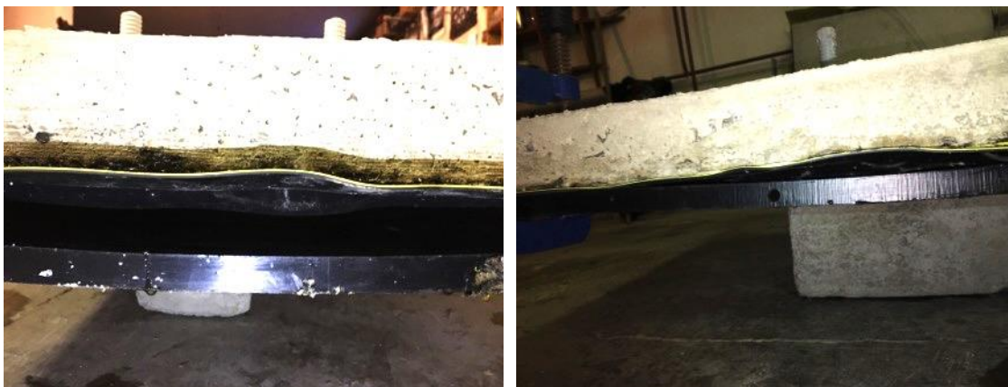
Obr. 65 – Fotografie zobrazujúce odchylenie HDPE platne od betónového bloku v miestach, kde platňa nebola zaistená sťahovacími svorkami [zdroj:autorka]
