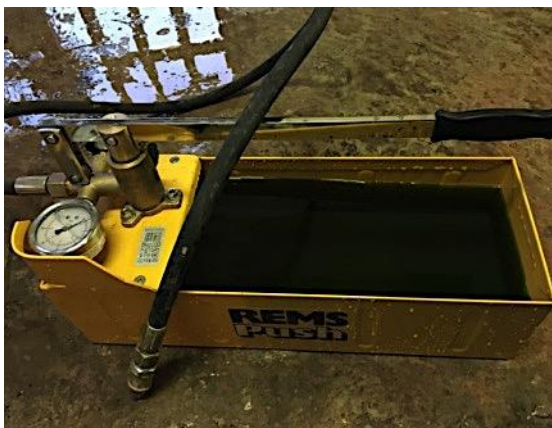
Obr. 61 – Fotografia ručnej injektážnej pumpy s pripravenou zafarbenou vodou pred samotným injektovaním do skúšobného bloku [zdroj:autorka]
