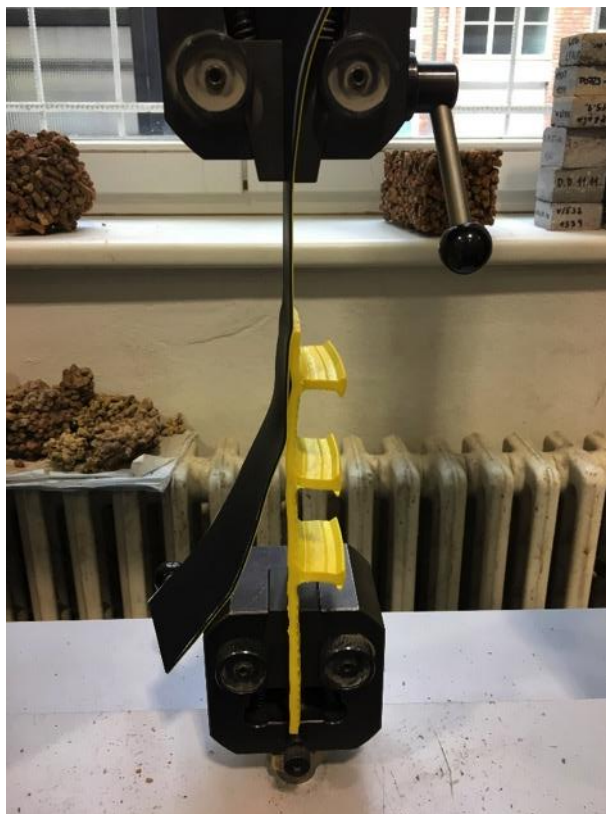
Obr. 43 - Fotografia skúšobného telesa v priebehu zaťažovania v skúšobnom zariadení [zdroj:autorka]
