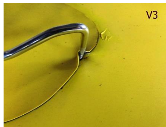
Obr. 51 – Zobrazenie identifikácie netesností vo vzorkách A6 a A8 pomocou odtrhovej ihly [zdroj:autorka]
