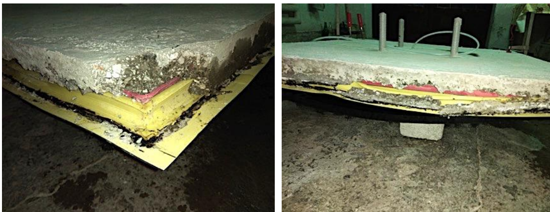
Obr. 67 – Zobrazenie porušení betónu počas injektovania, červený je bobtnavý pásik, ktorý zrejme svojou expanziou spôsobil odlúpenie betónu na krajoch skúšobnej vzorky [zdroj:autorka]
