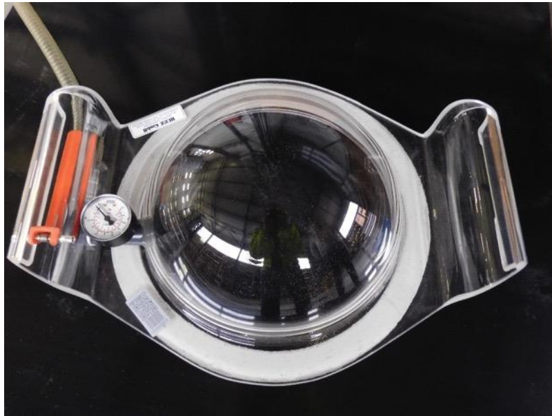
Obr. 41 – Fotografia vákuového zvonu použitého pre stanovenie tesnosti ručného zvaru [zdroj:autorka]
