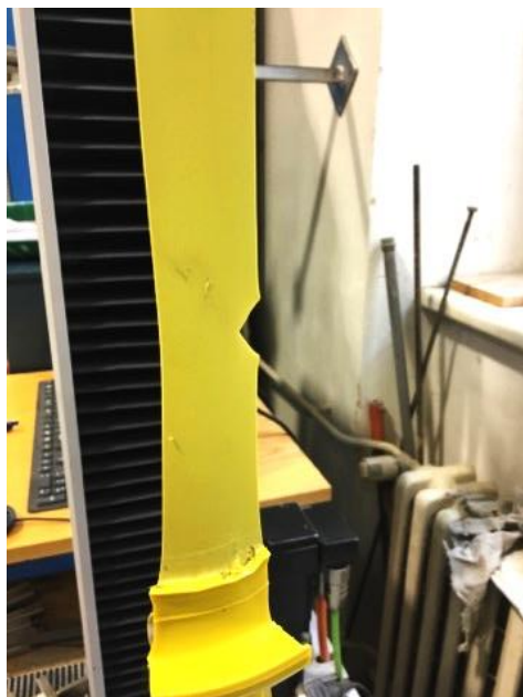
Obr. 56 – Zachytenie skúšobného telesa v priebehu skúšania šmykovej pevnosti, porušenie hydroizolačnej membrány mimo ručného spoja [zdroj:autorka]
