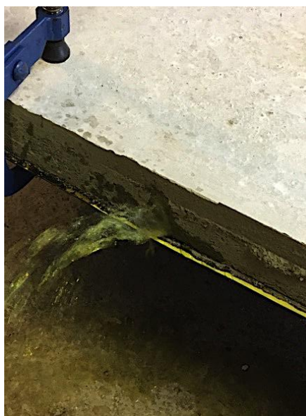
Obr. 63 – Zobrazenie preniknutia vody až za posledné rebro škárového pásu a vystreknutie z betónu, čím bolo meranie ukončené na bloku bez prítomnosti bobtnavého pásika [zdroj:autorka]
