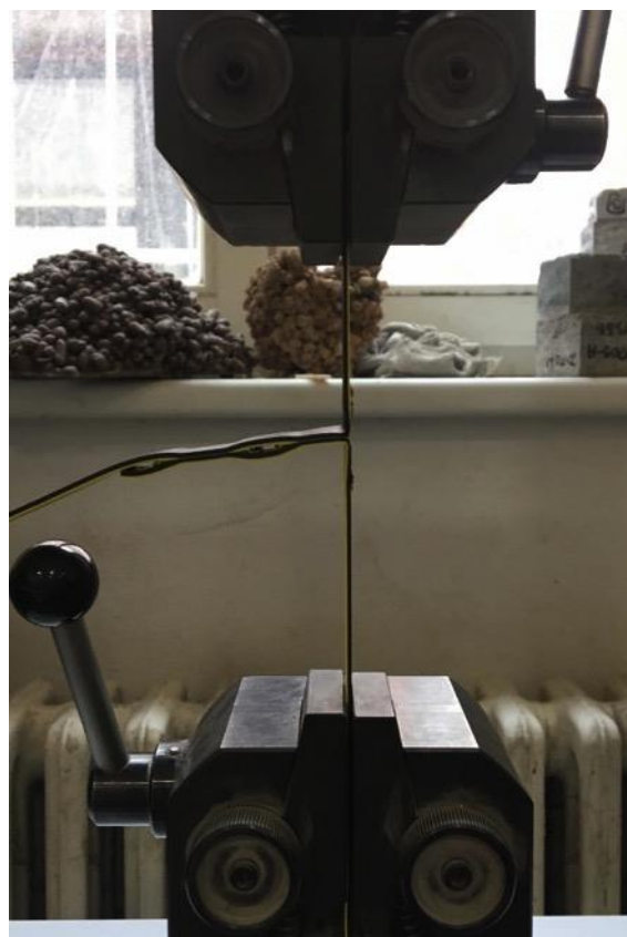
Obr. 35 – Fotografia skúšobného telesa počas prevádzania skúšky odolnosti proti odlupovaniu v skúšobnom zariadení [zdroj:autorka]
