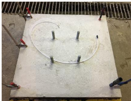
Obr. 62 – Zachytenie skúšobného bloku zaisteného s HDPE platňou pomocou sťahovacích svoriek [zdroj:autorka]
