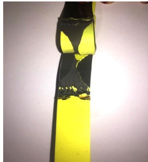
Obr. 50 – Zobrazenie skúšobného telesa 1.2. – A po porušení v spoji [zdroj:autorka]
