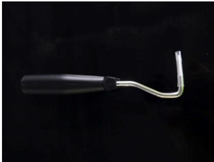
Obr. 40 - Zobrazenie skúšobnej odtrhovej ihly používanej pre skúšanie tesnosti ručného zvaru [zdroj:autorka]
