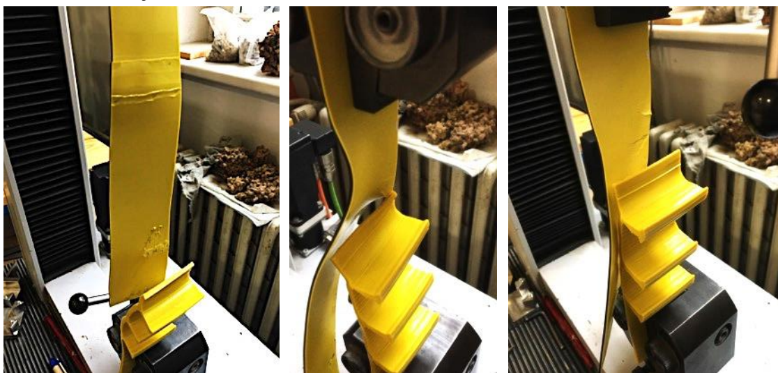
Obr. 55 – Vyobrazenie porušenia v mieste spoja, kde sa tesniaci škárový pás oddelil od izolačnej membrány [zdroj:autorka]
