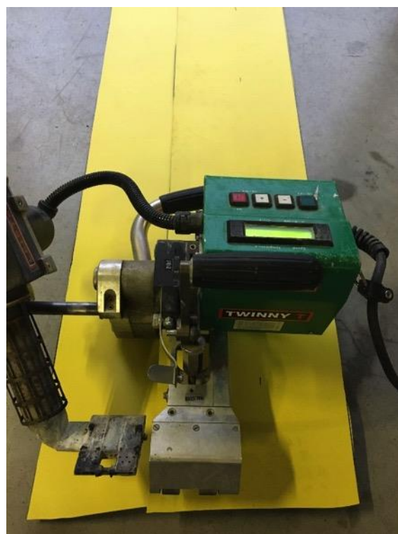
Obr. 31 – Zachytenie zváracieho automatu typu Twinny T pred prevádzkaním automatického spoja [zdroj: autorka]
