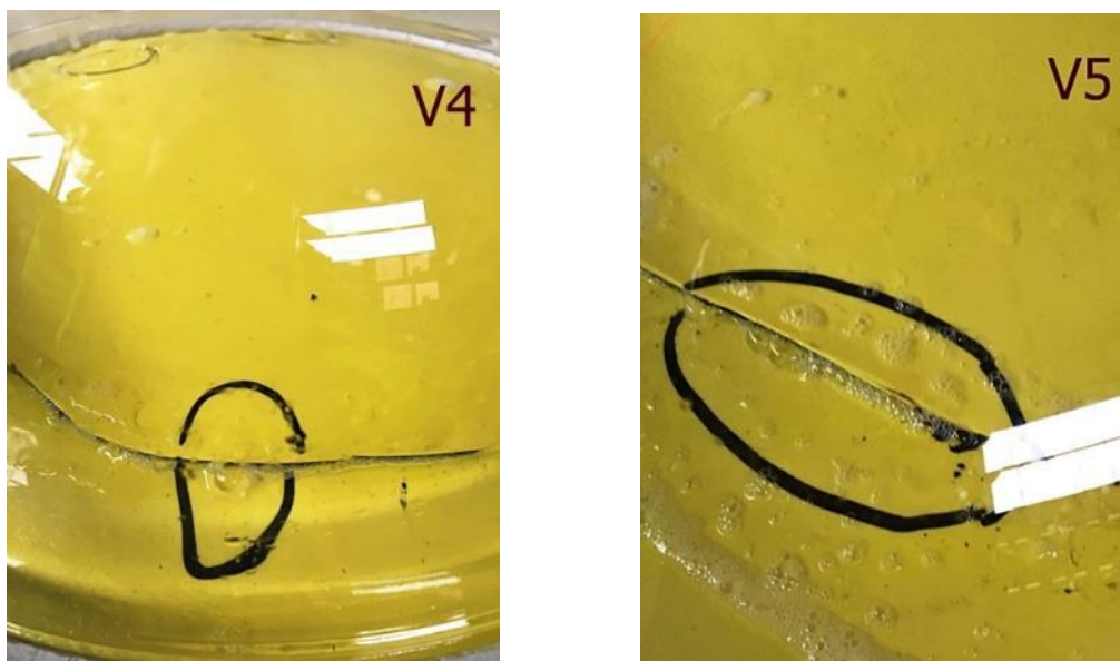
Obr. 54 – Zobrazenie priebehu vákuovej skúšky na vzorkách V2, V3, V4, V5 a identifikácia netesností v ručnom zvare [zdroj:autorka]
