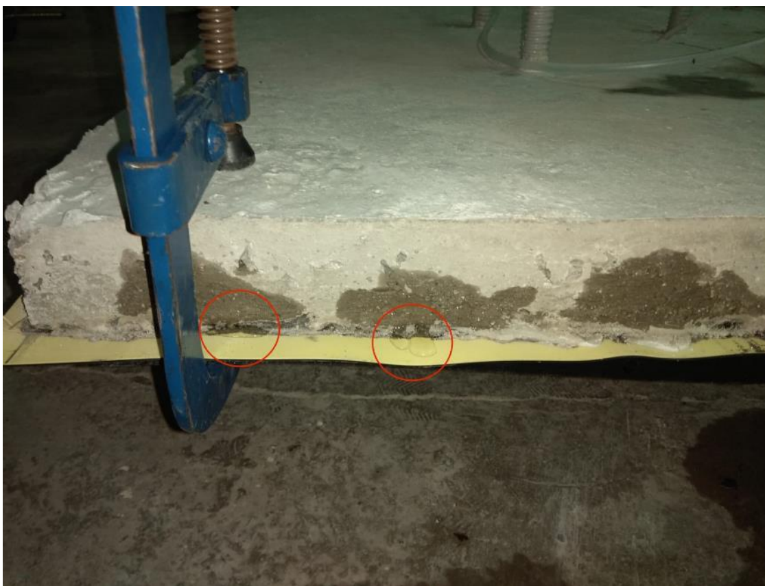
Obr. 66 – Zachytenie pretečenia vody cez posledné rebro škárového pásu a vytečenie z betónového bloku po nainjektovaní 25,5 litra [zdroj:autorka]
