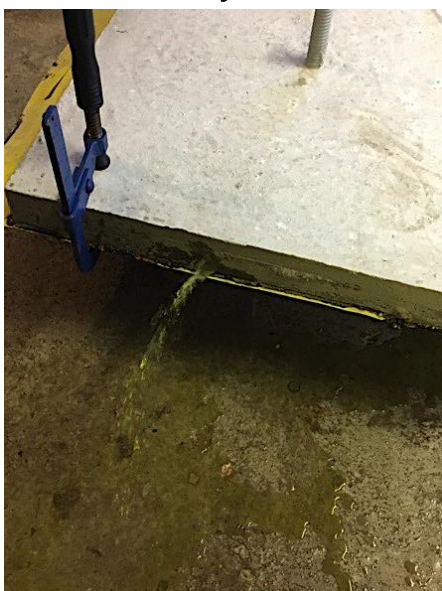
Obr. 63 – Zobrazenie preniknutia vody až za posledné rebro škárového pásu a vystreknutie z betónu, čím bolo meranie ukončené na bloku bez prítomnosti bobtnavého pásika [zdroj:autorka]
