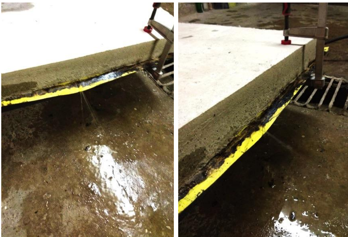
Obr. 68 – Fotografie, na ktorých je zachytený mierny prúd vody striekajúci z okraja skúšobného betónového bloku, po nainjektovaní 35,5 litra vody [zdroj:autorka]
