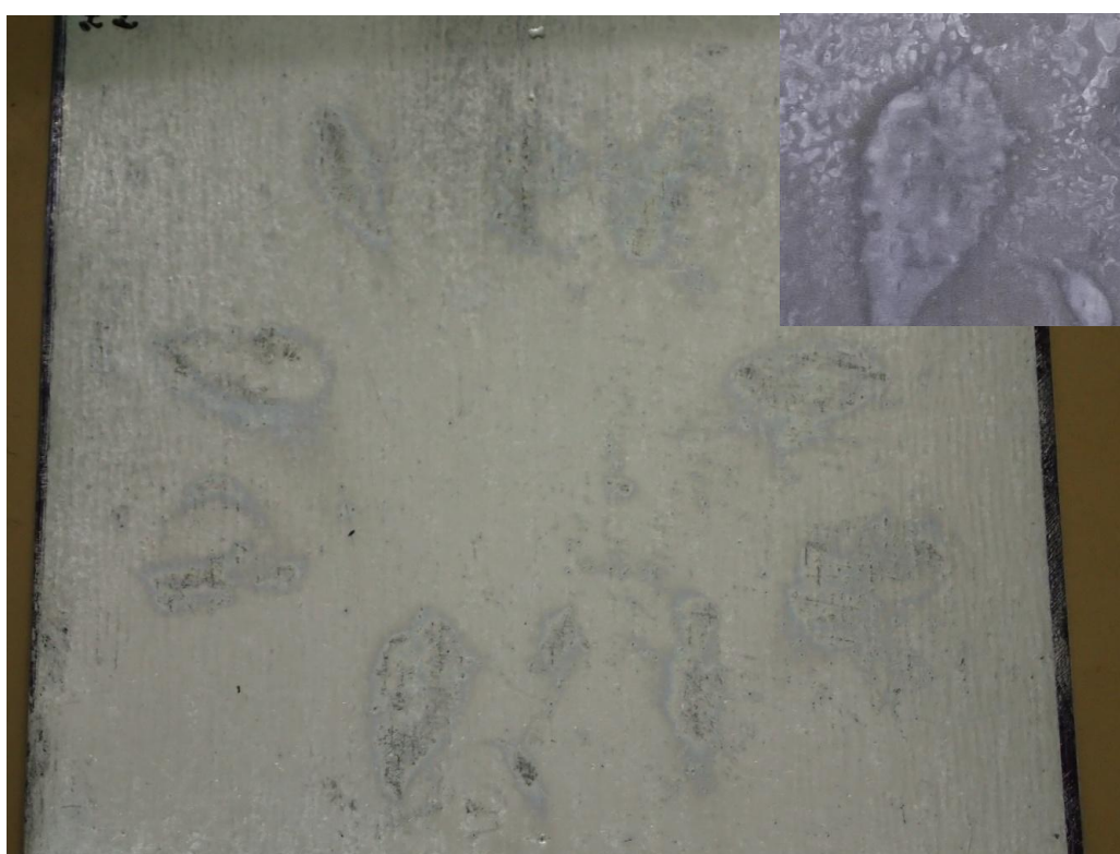
Obr. 8: Poškození zinkové vrstvy
