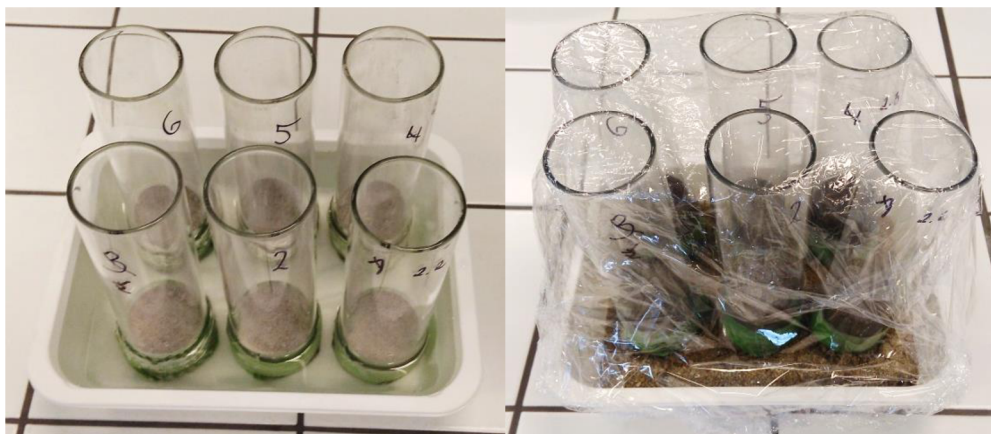
Obrázek 13: Stanovení maximální vodní kapacity (zdroj: vlastní)
