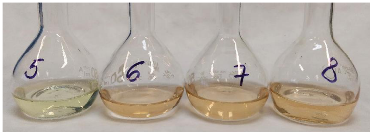
Obrázek 11: Zabarvení roztoků po extrakci acetonem – vzorek z dolní skládky (zkumavka č. 5 – blank, zdroj: vlastní)
