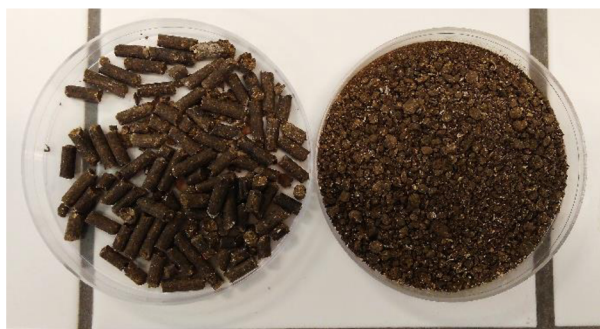
Obrázek 20: Granulované hnojivo (nalevo před drcením, napravo po drcení – zdroj: vlastní)
