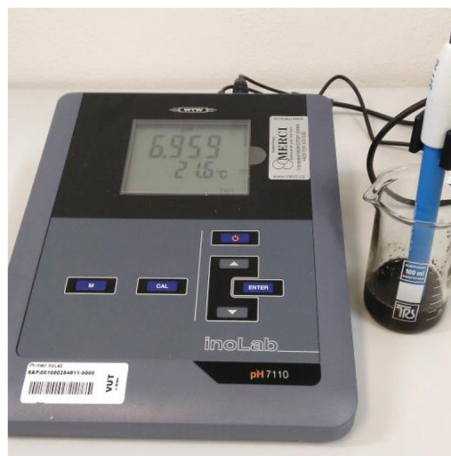
Obrázek 14: Měření pH metrem (zdroj: vlastní)
