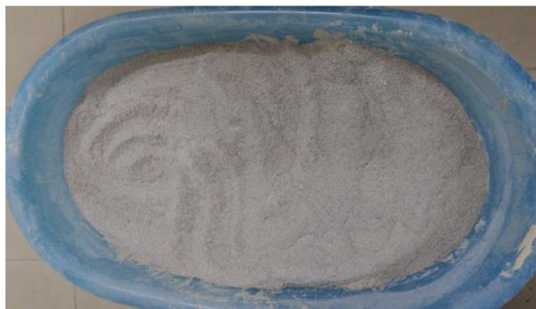
Obrázek 12: Artificiální půda po smísení složek (zdroj: vlastní)
