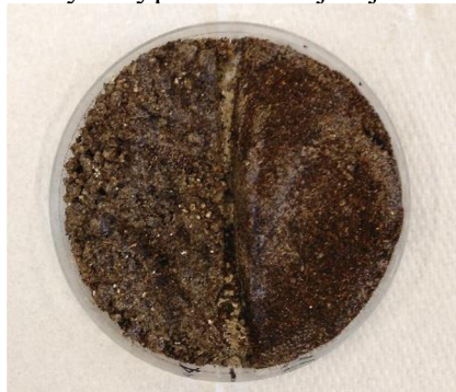
Obrázek 23: Miska s půdou připravená do testu (nalevo půda uměle vytvořená, napravo půda testovaná – zdroj: vlastní)
